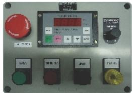
Com o painel de operação remoto você ganha tempo no start-up de sua máquina, onde com facilidade você possui as funções mais utilizadas nos inversores como potenciômetro externo, botões liga/desliga, velocidades pré-definidas, JOG, etc.
