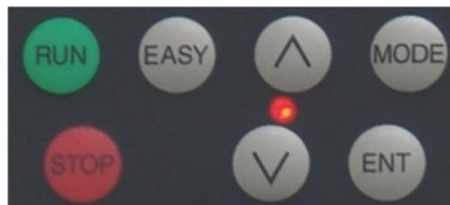
**RUN/STOP:** Usado para partir e parar o inversor quando o controle é via painel
